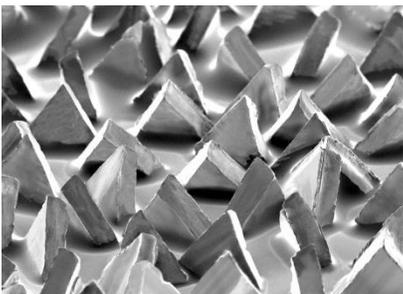
Basierend auf der keramischen Präzisionskorntechnologie generieren die 3M™ Fiberscheiben 787C exzellente Standzeiten und Abtragsergebnisse, besonders bei niedrigem und mittlerem Druck. Die besondere Konstruktion von 787C sorgt für eine niedrige Temperaturentwicklung bei den bekannten schlecht wärmeleitenden Edelmessingstählen.
